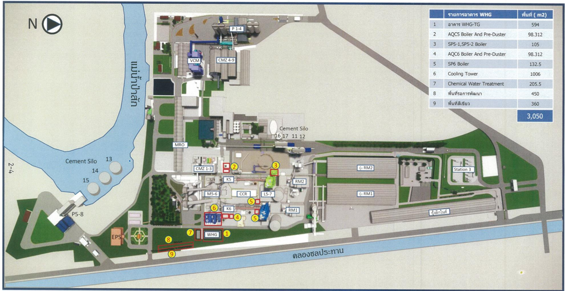
ภาพที่ 1.2 ตำแหน่งอุปกรณ์/เครื่องจักรของโครงการผลิตไฟฟ้าจากถ่านหินในโรงงานปูนซีเมนต์ท่าหลวง
